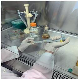
**Figura 2.** Transferencia de volumen a microplaca de 96 pozos con micropipeta de 100 µL.
