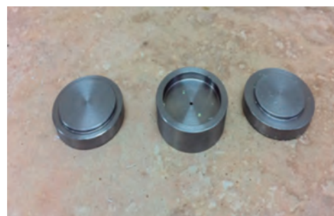
Figura 2. Dado de trabajo con el que se realizaron todas las tabletas para estandarizar el tamaño de todas las muestras con las medidas requeridas (5 mm de grosor x 20 mm de diámetro).
