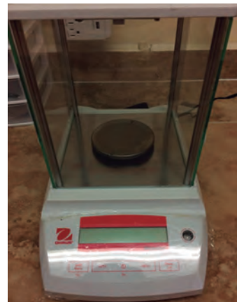
Figura 1. Balanza analítica Ohaus® (Pioneer™). La balanza es utilizada para la medición del peso del papel filtro, el Optosil® + Activador Universal Optosil®, de acuerdo al índice de Edlund y Lamm. 5
