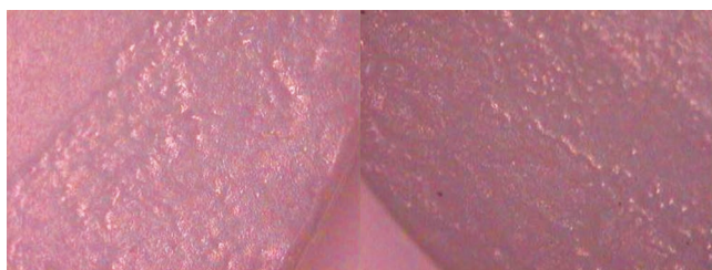
Figura 3. Resina a las 300 horas con rugosidades.
