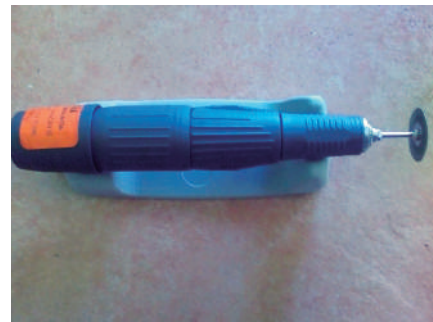
Figura 7. Corte de las piezas por secciones.
