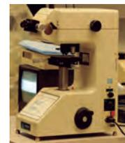
Figura 4. Aparato de micro-dureza Buehler.
