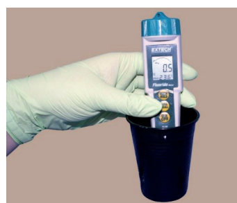
Figura 6. Medición de iones de fluoruro de cada disco muestra con el medidor de fluoruro ExStik FL700.
