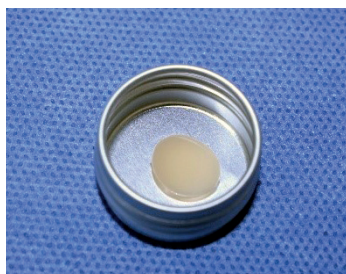
Figura 3. Almacenamiento en frascos de aluminio con 5 ml de agua desionizada.
